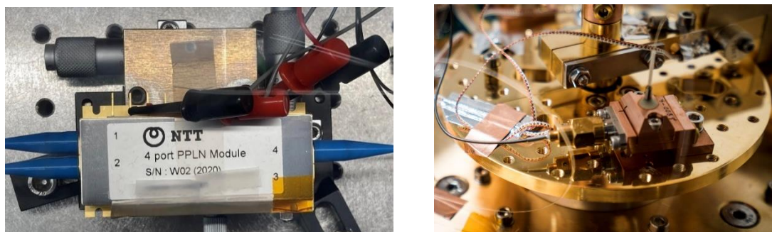
図 2 : 光パラメトリック増幅器(左、OPA)と超伝導光子検出器 (右)
