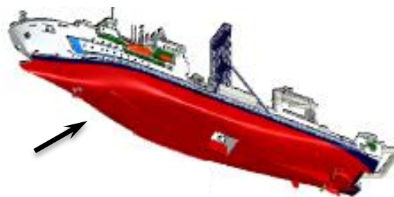
白嶺船底ドームに取り付けられたマルチビーム音響測探装置(MBES)
