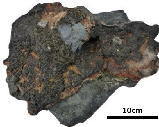
写真 閃亜鉛鉱、黄鉄鉱、重晶石、マンガン酸化物からなる硫化鉱石 (品位分析結果は表の鉱石⑥)
