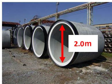
推進用鉄筋コンクリート管
