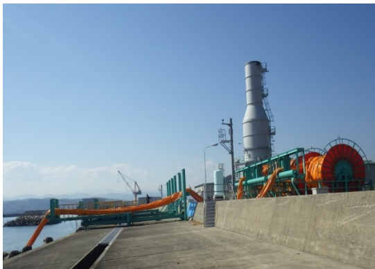
オイルフェンスの引き出し
