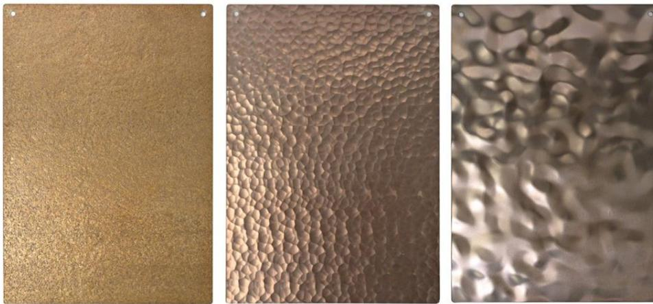
「ブロンズ」塗装を施した IZUNA、HAMMER、波の自在成形パネル
