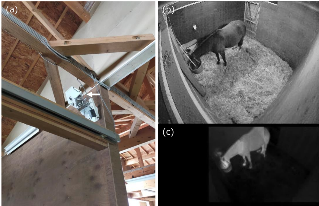
(a) 分娩馬房に設置したカメラ、(b) 可視画像、(c) サーマル画像
