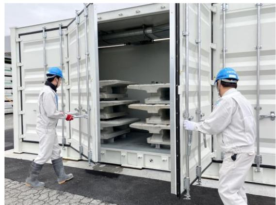
CO<sub>2</sub>-SUICOM炭酸化養生槽のイメージ
