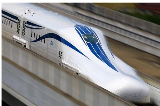
超電導リニアでは、事前に作成された走行パターンに基づき、変電所から地上側の地上の推進コイルと浮上・案内コイルに電流が流れ、自動的に列車が走行します。推進コイルに流す電流の大きさと周波数を変えることで、列車の加減速も制御されています。そのため、超電導リニアの運営上、推進コイルへの送電を担う送電設備の正常稼働をリアルタイムで状態監視することは重要です。
