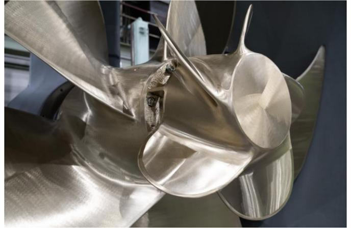
1986年に商船三井、株式会社西日本流体技研、ナカシマプロペラ株式会社（開発当時の社名はミカドプロペラ株式会社）が共同開発したPBCFは、船舶の燃料消費量を平均3～5%削減する省エネ装置です。プロペラ後方に発生するハブ渦を解消することでプロペラの推進効率を改善し、大型コンテナ船1隻に装着した場合、年間約9,000トン以上のCO2排出量削減効果があります。2021年12月には「最も販売されている船舶用省エネ装置ブランド（累計個数）」としてギネス世界記録™に認定され（註2）、2024年5月末現在の販売数は4,178隻に達しました。PBCFによってこれまで累計で約6,700万トンのCO2排出量削減に貢献したと算出されており、開発・製品化から37年を経た現在でも、環境意識の高まりとともにその価値を再認識され、さらなる成長を続けています。（詳細については[商船三井テクノトレードのウェブサイト](#)をご参照ください）
