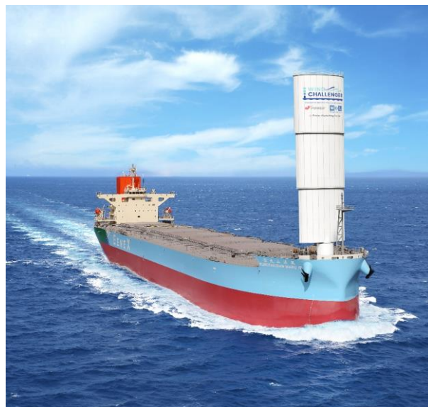
ウインドチャレンジャーを搭載した「黒滝山丸III」（イメージ図）
