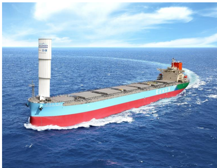
ウインドチャレンジャーを搭載した「黒滝山丸III」（イメージ図）
