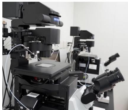
最新のレーザーシステムを搭載した マイクロマニピュレーター（2台）
