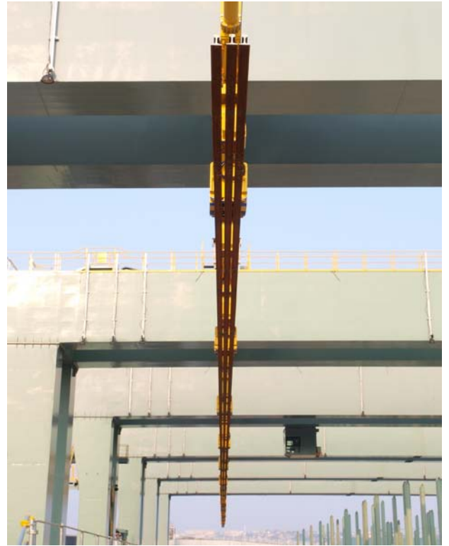
150M レールの出荷の様子
