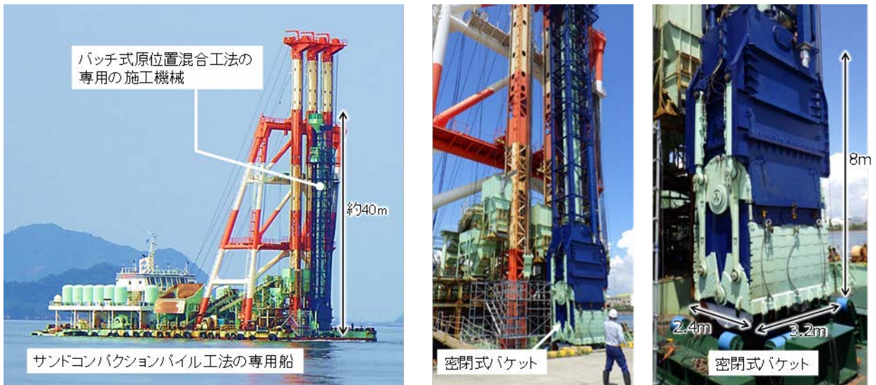
【図4】バッチ式原位置混合工法の施工船
