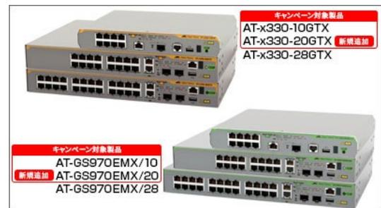
「AT-x330-20GTX」は、アップリンクには 10G マルチギガビットポートと SFP+スロット、ダウンリンクには 1 ギガビットポートを搭載したレイヤー3 インテリジェント・エッジ・スタックブル・スイッチです。また、VCS<sup>(※1)</sup> 機能や RIP<sup>(※2)</sup>、OSPF<sup>(※3)</sup> といったダイナミックルーティングにも対応しているため、支店や支所のような小規模ネットワークにおいて、コア・スイッチとしてご利用いただくことも可能です。
