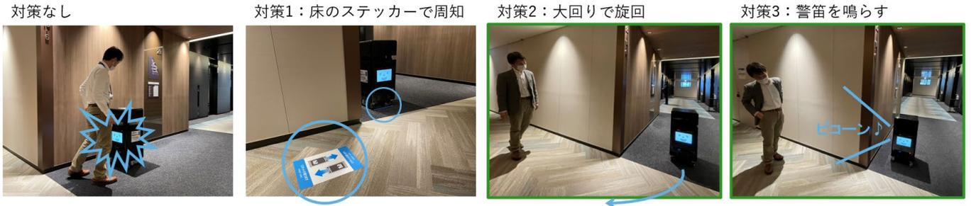
図：曲がり角における人とロボットの衝突を避ける実証実験の例
