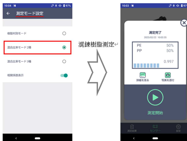
図「混合樹脂の比率・純度測定機能」測定イメージ
