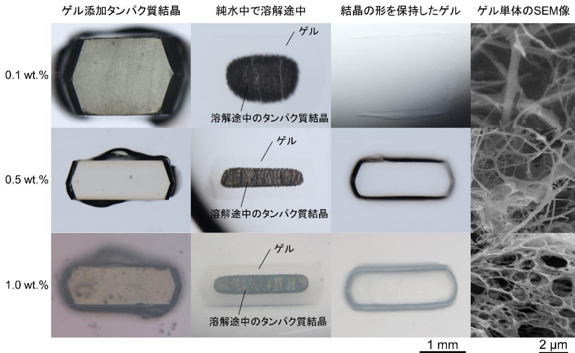
図4 結晶を純水中で溶解させた様子とゲル単体の電子顕微鏡写真
