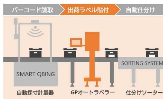
▲自動ラベル貼り付け機と自動採寸計量器、自動仕分け機との接続イメージ
