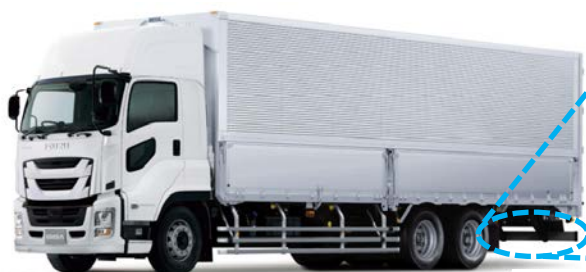
図 1. 後部突入防止装置 （画像提供：いすゞ自動車株式会社）
