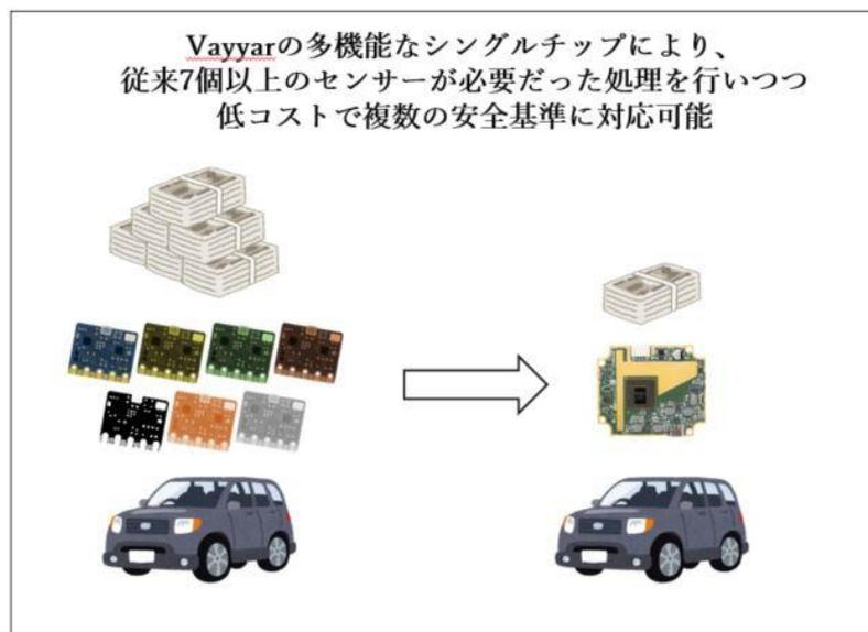
Vayyar の最先端の車内監視プラットフォームなら、低コストかつ多機能なシングルチップソリューションである 4D イメージングレーダーチップを 1 個搭載するだけで、ユーロ NCAP の最も厳しい安全基準要件を今後数年間達成することが可能です。このプラットフォームは幼児置き去り検知に加え、高度なシートベルト着け忘れ防止、エアバッグ解除装置、乗員監視まで、幅広い安全機能を一括してサポートし、従来 7 個以上のセンサーが必要だった処理が 1 個のセンサーチップで済みます。メーカーは 1 個のチップで複数の安全基準に対応でき、ユーロ NCAP の乗用車向け車内安全性評価で最高 7.5 点を獲得できるようになります。
