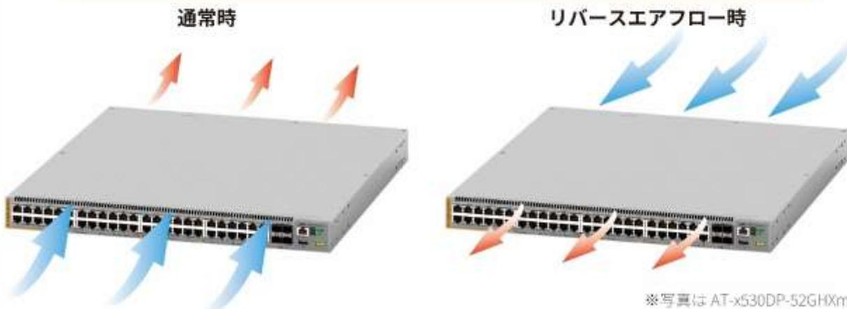
新発売の AT-PWR150R-70 と AT-FAN10R を使用することで、AT-x53 ODP-28GHXm/52GHXm をリバースエアフロー方式（背面吸気 + ポート面排気）に変更可能
