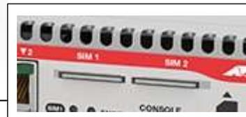
2枚のSIMを機器本体に直接差し込めます。
