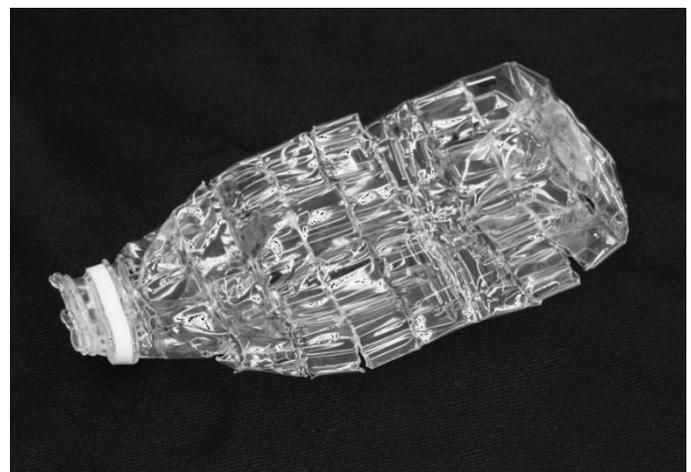
▲プレ裁断圧縮方式により減容したペットボトル
