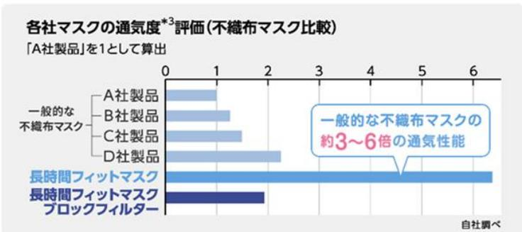
PFE: 平均 98% (0.1 $\mu$ m 微小粒子捕集効率試験)\*<sup>2</sup>
