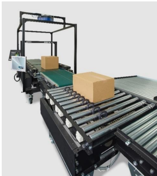
▲自動採寸計量スケール「SMART QBING」と自動仕分け機「SORTING SYSTEM」の接続イメージ
