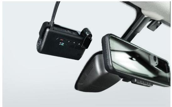
専用のドライブレコーダーは、フロントカメラに加えてオプションでリアカメラもご用意しています。いずれもフルHD対応の高画質で常時録画が可能。その他、レンタカーにおいてトラブルの原因となる録画映像の拡散や録画停止による証拠隠滅の対策として、特殊ネジで固定したカバーを被せることにより、映像を保管するSDカードおよび電源ケーブルの抜き差し防止を実現しています。さらに、レンタカー利用者のプライバシーを考慮した機能として、次のレンタカー利用者に貸し出す前に、特定のボタンを長押しする簡単操作で速やかに録画データを削除できる機能も搭載しています。
