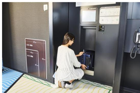
「BAGGAGE KEEPER(バゲッジ キーパー)」は、荷物を個別に収納する大・小の収納ボックスが並んだラックと、荷物を自動搬送する搬送機、荷物の出し入れ口と無人受付を行う操作部で構成された自動搬送型荷物保管システムです。荷物の効率的な収納と荷物預かりの省人化を実現し、非接触での対応が可能なので、新たな生活様式にも対応しております。
