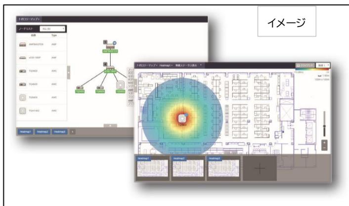
アクセスポイントの電波出力や接続構成を認識し、自動で調整してくれます。さらに左のイメージ図のようにLANのトポロジーマップが表示されるので、ネットワークに関する詳しい知識がなくても、直観的に管理が可能となります。ネットワークの状況が可視化されることで、専任の担当者が立てられない場合や、担当できる人が1人しかいないような場合でも、スムーズに管理することができます。サーバーレスなので最小限のコストでマネジメントが可能となることもポイントです。
