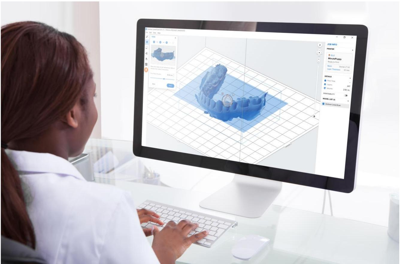
これは、口腔内スキャンを 3D プリント可能なモデルに簡単に変換できるように設計されています。歯科や歯科矯正の医療従事者は、デジタル歯科医療用設計ソフトウェアの経験が少なくても、「Scan to Model」をデジタルワークフローへの入り口として活用できます。患者の歯を 3D 口腔内スキャナでスキャンし、そのデータをそのまま PreForm に読み込み、「Scan to Model」機能を使用し、Formlabs Form 3B プリンタでプリントします。一連のプロセスは最短 1 時間で完了します。
