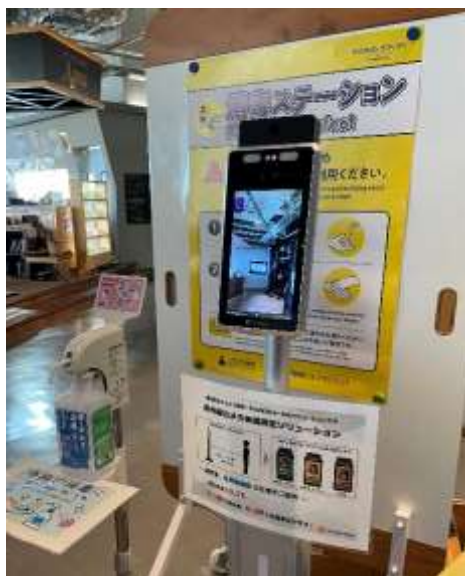
KOIL 入口に設置されたサーモカメラ
