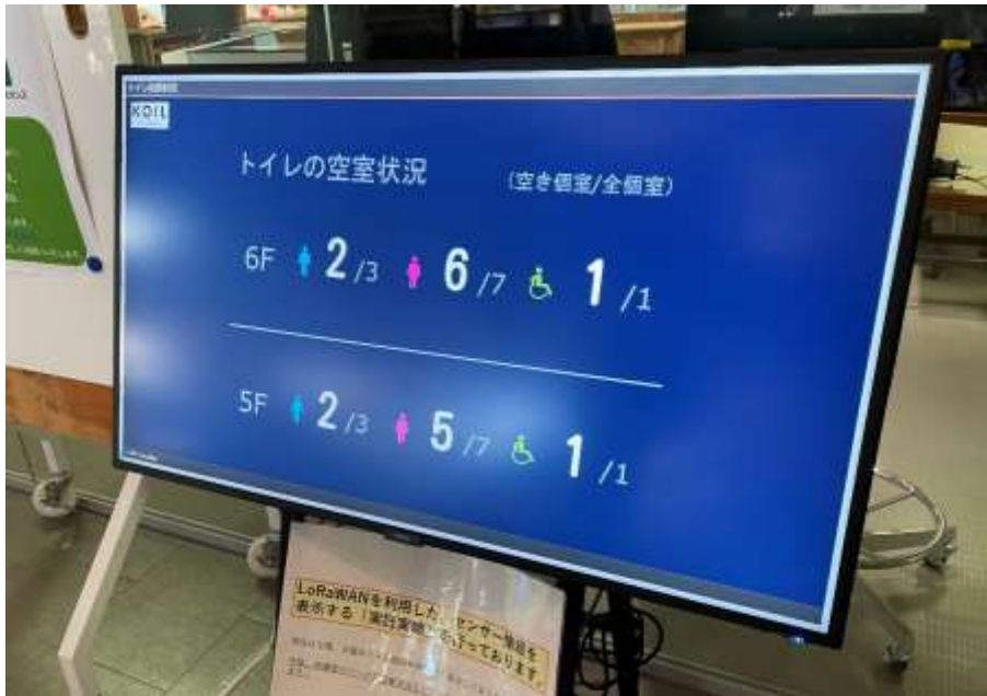
KOIL 内のセンシングデータを表示するサイネージ
