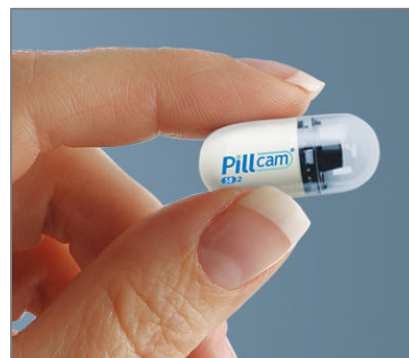
PillCam® SB 2 カプセル: 11 × 26mm と大きめのビタミン剤程度。 これまで 80 か国以上で 150 万人以上の使用実績があります
