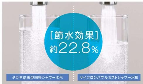
（※6）サイクロンバブルミストシャワー（シャワー孔φ0.43mm×72 個+ミスト孔φ0.7mm×12 個）とタカギ従来型と同等のシャワー水形（既存製品と同等仕様（シャワー孔φ0.6mm×150 個）をキレリストのスクリーンサイズで再現）を使用し、静水圧 0.3MPa にて 60 秒間吐水した際の流量を比較した結果（2020 年 10 月タカギ開発調べ）
