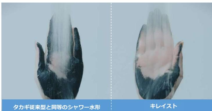
(※4) サイクロンバブルミストシャワー (シャワー孔 $\phi$  0.43mm $\times$ 72 個+ミスト孔 $\phi$ 0.7mm $\times$ 12 個) とタカギ従来型と同等のシャワー水形 (既存製品と同等仕様 (シャワー孔 $\phi$ 0.6mm $\times$ 150 個)) をキレイストのスクリーンサイズで再現) を使用し、疑似汚れ (墨汁で着色したヘアワックス) を塗布した人工皮膚に水流 (静水圧 0.3MPa) を 5 秒間あて、流れ落ちた疑似汚れ (墨汁で着色したヘアワックス) の重量を比較した結果 (2020 年 10 月タカギ開発調べ)
