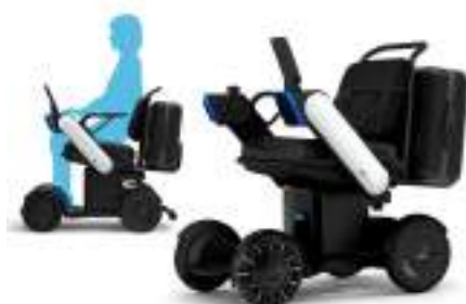
自動走行・衝突回避機能を備えた WHILL 自動運転パーソナルモビリティ
