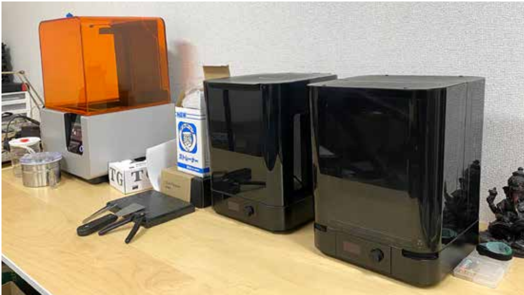
古賀氏がパドルの試作開発に利用している3Dプリンタ「Form 2」と、洗浄・二次硬化を行う「Form Wash」と「Form Cure」
