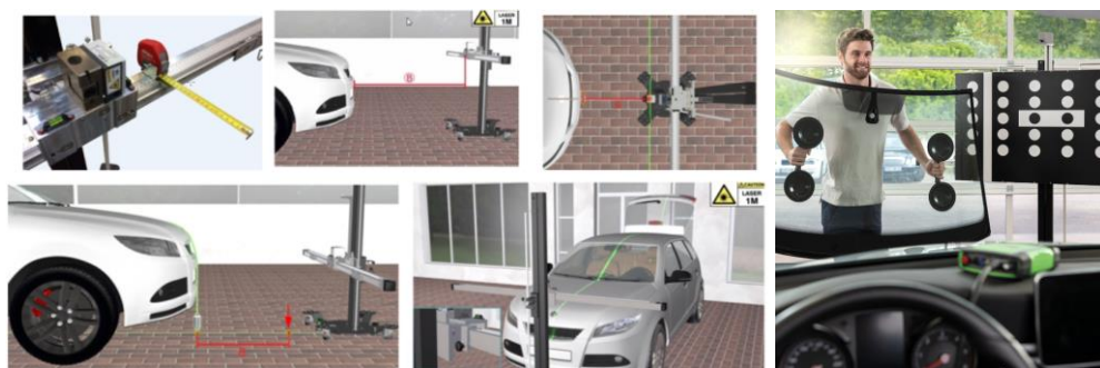
レーザー光を使用したボッシュ ADAS エーミングツールを用いた作業風景
