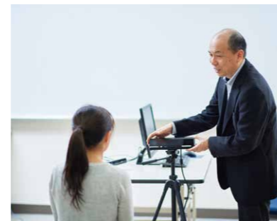
RGB (Red Green Blue) カメラで得られたカラー画像から脈波などの生体信号を抽出する非接触センシング技術の研究開発風景
