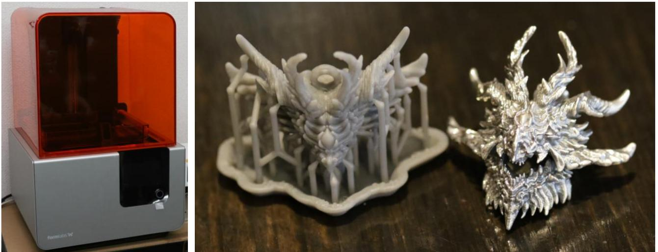
（左：工房の壁際に設置された「Form 2」。右：Form 2 で「Grey Resin」を使って出力したペンダントヘッドと完成品）
