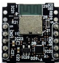
Spresense に Bluetooth® LE 通信機能を追加し、Bluetooth®対応機器との接続を可能にするものです。パターンアンテナを内蔵し、回路調整済みであることに加え、日本 (TELEC)、米国 (FCC)、欧州地域 (CE) における無線法令規制の認証、また Bluetooth® SIG 認証を取得済みです。Arduino および NuttX 向けソフトウェアとスマートフォンアプリを提供し、簡単に通信評価を行うことができます。
