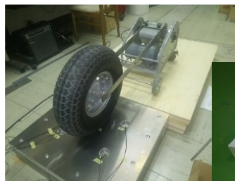
【固有振動数実験状況】
