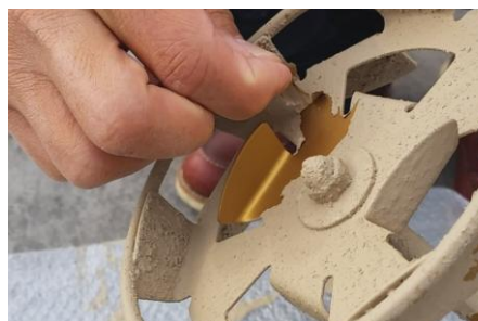
洗浄せず塗料がスクリー部に固着した状態
