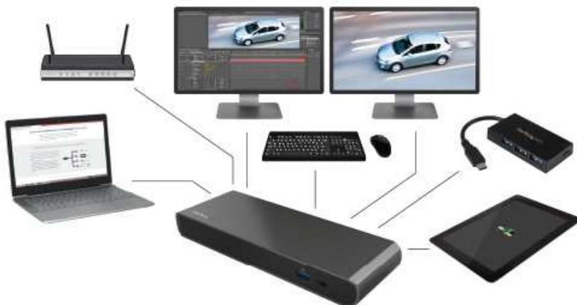
TB3DK2DPW は、2 つの Thunderbolt™ 3 USB-C ポートが内蔵されており、Thunderbolt™デバイスと、USB-C コネクタを使用するその他のデバイスを接続することができます。デュアル 4K ビデオを使用するには、4K 60Hz 対応のビデオアダプタを使用し、ドックの Thunderbolt™ 3 USB-C 周辺機器ポートの 1 口に 2 台目の 4K 60Hz ディスプレイを接続します。
