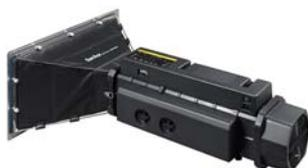
■測定範囲：風量 0.20～8.00 m<sup>3</sup>/min, 静圧 0～1000Pa, 測定精度：風量 各ノズルでの測定可能最大風量の±7%, 静圧 200Pa 以下の測定結果に対して±10Pa, 200Pa 以上の測定結果に対して±50Pa, 使用・保存環境：周囲温度 0～40℃, 湿度 20～85%RH (結露なきこと), 質量：本体 約 6kg, 接続ダクト (ボードホルダー込み)：約 1.5kg
