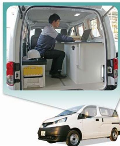
車両は、日産「NV200」を改造し、カーナビや ETC 車載器のほか、事務所機能として収納機能付き椅子とテーブル、車両用 DC12V から AC100V への電源変換インバーター、外部電源取り出し機能、LED ルームランプ、後部座席ウィンドウフィルムとカーテン、エンジン停止時に使用可能な簡易型エアコンを装備しています。基本料金は 12 時間 13,500 円とし、貸出期間・台数に応じた割引価格で個別見積りを行います。お客さまを迎え入れる移動店舗車両とは異なり、事務作業を行うのに最低限かつ必須な機能に絞り込むことで、導入コストを抑えています。
