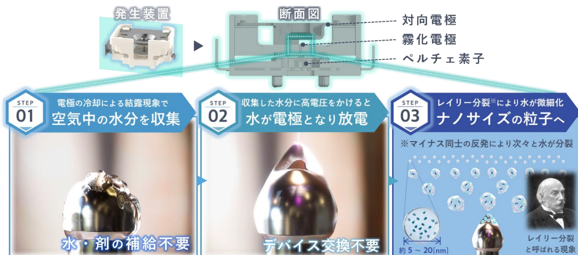
図 5 ナノイー(帯電微粒子水)発生装置
