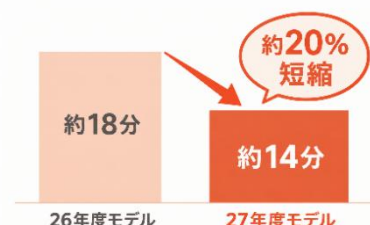
外気温 2℃以下における「ヒートブースト制御」と「ヒートブースト制御（外気温運動）」の設定温度への到達時間
