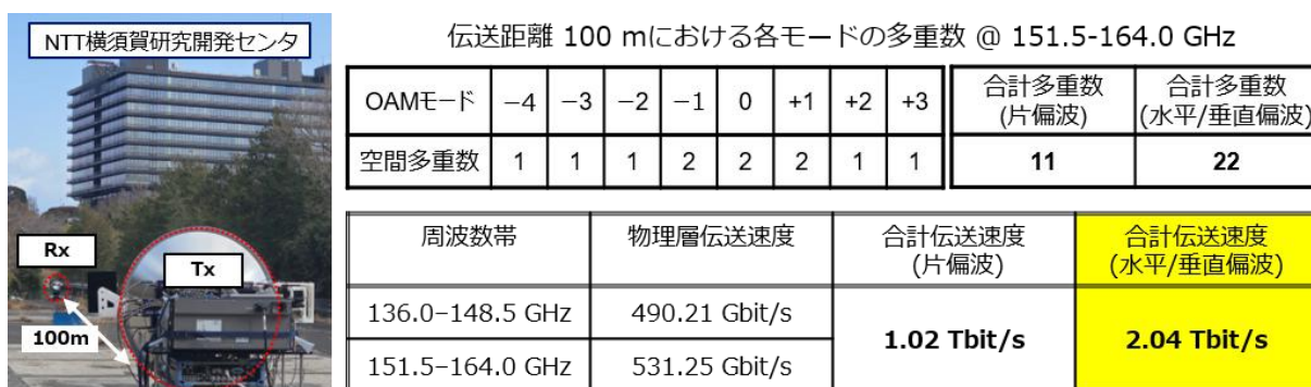
図 4 フィールド実験の様子と無線伝送実験の結果
