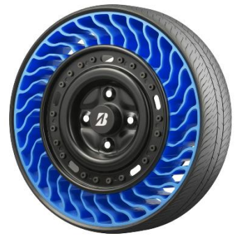
空気充填の要らない次世代タイヤ「AirFree」
