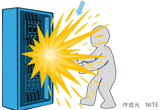
〔図 5〕 アークによる事故の概念図例
