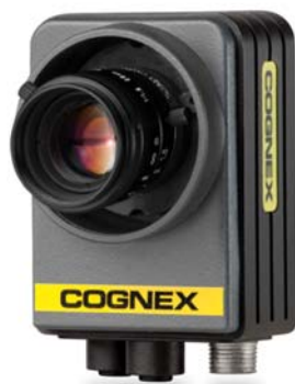
In-Sight EZ-700 シリーズ C マウントレンズモデル (左:レンズカバーなし / 右:レンズカバー付き IP67)
