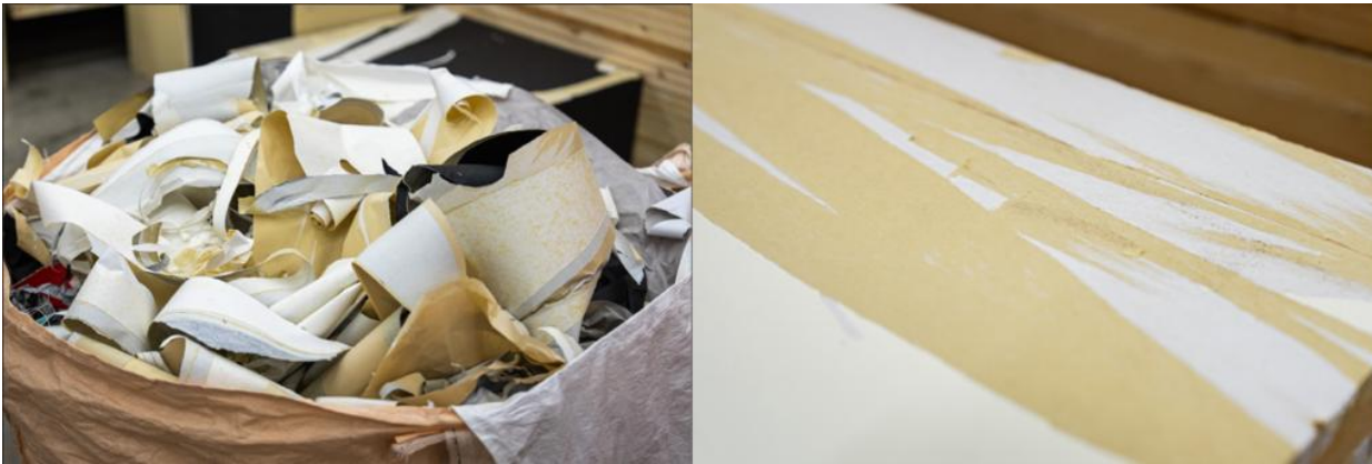
従来の方法で接着後剥がした表具と木工パネル：きれいに剥がせず、パネルに残ってしまう
